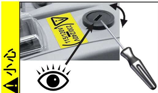
设置电压选择开关的电压范围：
