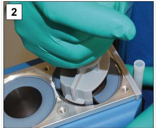
2. Zet de membraansleutel voorzichtig op de membraansteuning.
