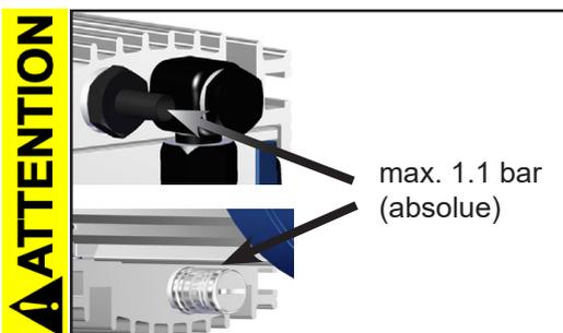
• Vérifiez la compatibilité avec la **pression maximale admissible** à l'aspiration et au refoulement.
