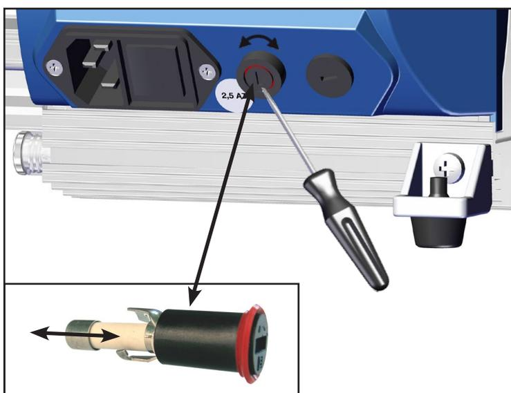
➔ A l'aide d'un tournevis démontez le porte-fusible à côté de la pompe.
