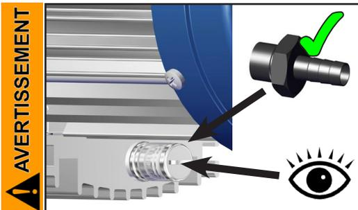
☞ Une opération de la pompe pour quelque temps à une pression d'aspiration augmentée ou en pompant des gaz chargés de poussière peut causer un bouchage du silencieux. Contrôlez la perméabilité du silencieux à intervalles réguliers. Echangez le silencieux, le cas échéant ou remplacez-le par un embout.
