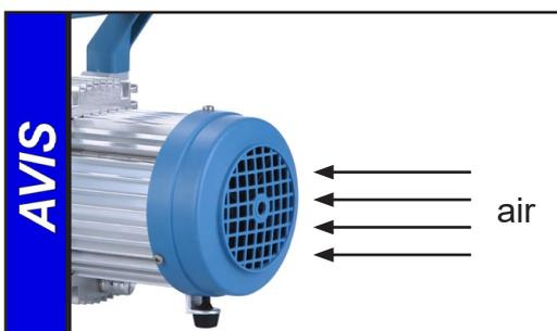
Veillez à une amenée d'air adéquate au ventilateur. Contrôlez régulièrement les grilles de ventilateur et nettoyez des grilles encrassées évitant une restriction d'amenée d'air.
