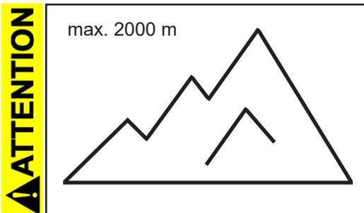
• Si la pompe est installée à plus de 2000 m au-dessus du niveau de la mer, vérifiez la compatibilité avec les exigences de sécurité (refroidissement insuffisant).
