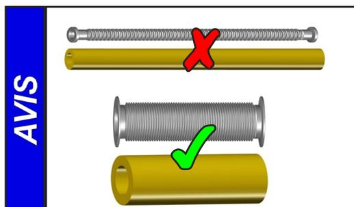
Evitez les pertes d'étranglement en utilisant des tuyaux de raccordement aussi courts que possible et à large diamètre.
