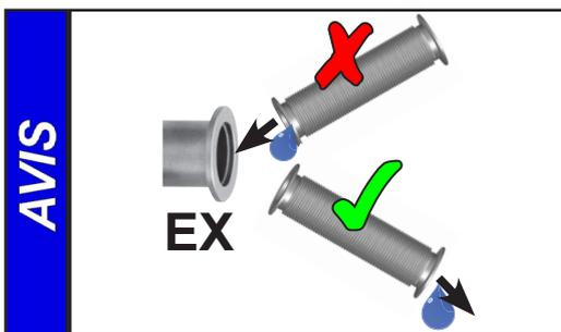
Prenez les mesures appropriées pour prévenir le reflux du condensat à partir de la conduite d'échappement vers la pompe, p.ex. en posant les conduites d'échappement en les inclinant vers le bas.
