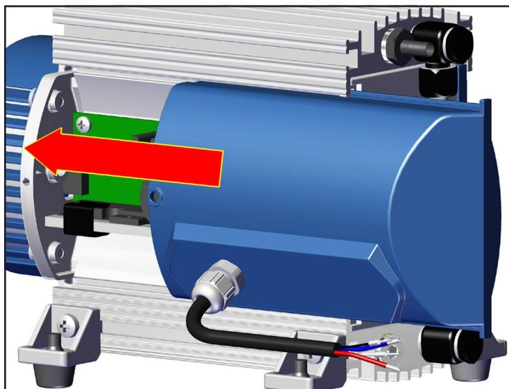
Assemblez le couvercle après le remplacement du fusible.
