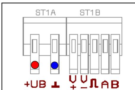
☞ Assurez qu'il y a aucun signal de commande aux bornes de connexion ST1B, p.ex. en enlevant des cordons blanc et noir.
