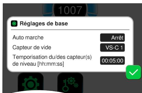
Réglez la **temporisation du capteur de niveau** dans le menu «Paramètres/Réglages de base».
