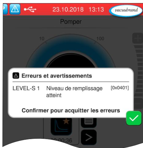
La temporisation du capteur de niveau s'est écoulée. Le process en cours est arrêté. Il y a risque d'un débordement du ballon collecteur.
