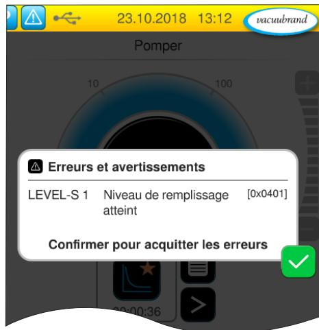
Le déclenchement du capteur de niveau ne résulte pas dans un arrêt tout de suite de process. Le process en cours continuera jusqu'à ce que la temporisation du capteur de niveau soit atteinte. Réglez la temporisation du capteur de niveau au régulateur.
