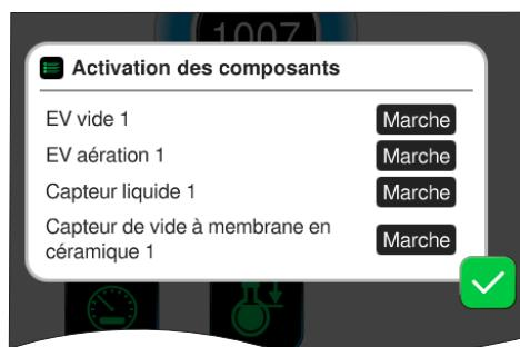
**L'activation des composants** vous permet d'activer ou de désactiver un capteur de niveau raccordé. En d'autres termes, le capteur de niveau peut rester raccordé mais est mis sous tension ou hors tension au niveau du régulateur selon les besoins du process en cours.
