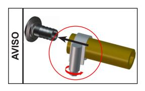
Asegure las conexiones de la manguera para que no puedan soltarse de forma no intencionada (p. ej.: utilizar abrazaderas de manguera).
