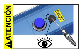
Ajustar el rango de tensión en el interruptor de alimentación eléctrica:
