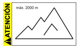
Si el lugar de colocación está a una altitud superior a 2000 m sobre el nivel del mar (peligro de un suministro de aire de refrigeración insuficiente), se deben adoptar medidas y precauciones pertinentes.
