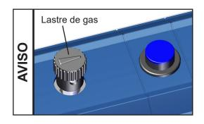
Si se transportan vapores condensables, se debe operar la bomba (MZ 1C) con un lastre de gas para reducir la condensación de las sustancias bombeadas (vapor de agua, disolvente, etc.) en la bomba.
