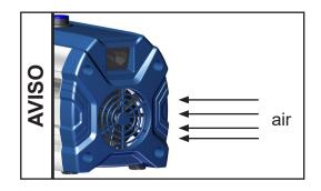
Asegure siempre un suministro de aire suficiente en el ventilador. Compruebe el ventilador de forma regular en busca de suciedad. Limpie la rejilla del ventilador sucia para evitar reducciones en el suministro de aire.
