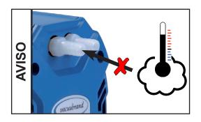
Evite aportes de calor fuertes (p. ej., por gases de proceso calientes). Rango de temperatura admisible: véase «Características técnica / Temperaturas de aspiración de gases».
