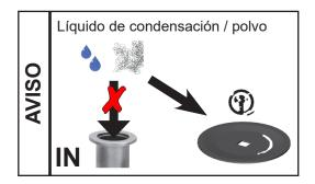
Evite condensación en la bomba, así como bloqueos hidráulicos y polvo, porque el transporte continuado de líquido o polvo daña la membrana y las válvulas.
