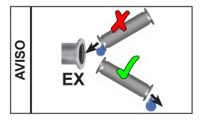
Las líneas de escape deben instalarse siempre hacia abajo o adoptarse medidas para evitar el reflujo de líquido de condensación en la bomba de vacío.
