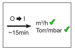
La bomba alcanza los valores introducidos para la potencia de succión y el vacío final, así como la compatibilidad con vapores (MZ 1C) solo a la temperatura de funcionamiento (después de unos 15 minutos).
