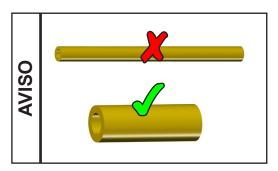
Utilice tuberías de conexión de vacío lo más cortas posibles con un diámetro interior grande para evitar pérdidas por estrangulación.
