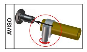
Asegure las conexiones de la manguera para que no puedan soltarse de forma no intencionada (p. ej.: utilizar abrazaderas de manguera).
