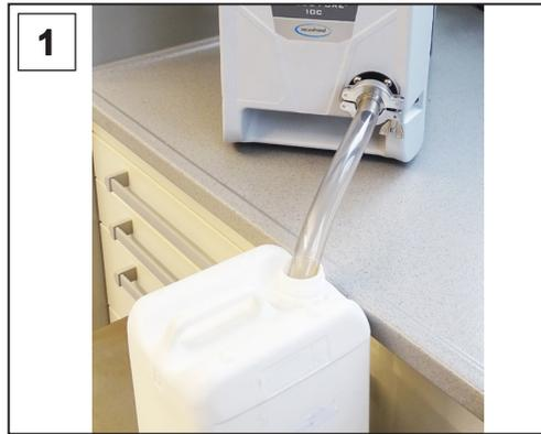
1. Cierre una línea de salida en la salida y dirija esta hacia abajo hacia un colector colocado de forma estable.
