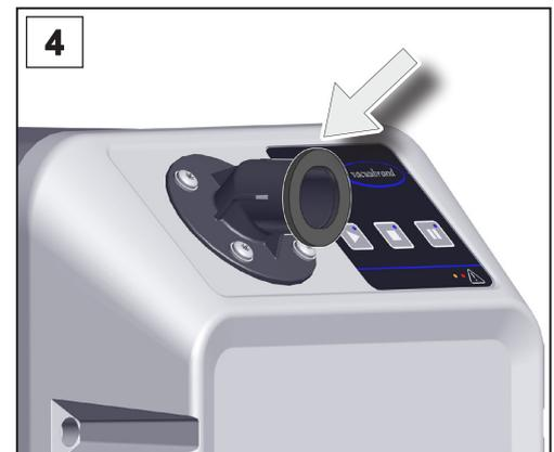
**4.** Apriete la brida de entrada con las arandelas; utilice un destornillador Torx TX25.
