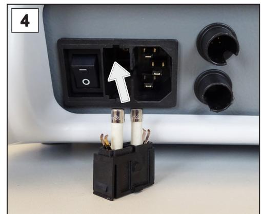
4. Vuelva a insertar el fusible en el zócalo hasta que se enganche.
