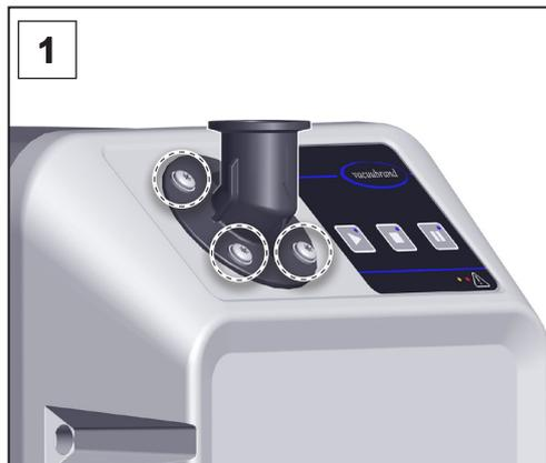
**1.** Suelte los 4 tornillos en la brida de entrada; utilice un destornillador Torx TX25. Preste atención a las arandelas.
