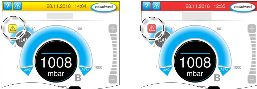
Warnungen und/oder Störungen werden in der blinkenden Druckkurve angezeigt. Wird diese Druckkurve angetippt, lässt sich der Prozess mit Störung aufrufen. Der Prozess ohne Störung läuft weiter. Sollten beide Prozesse von der Störung betroffen sein, stoppen beide Prozesse.
