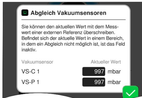
Bedienfeld für den **Abgleich** angeschlossener **Vakuumsensoren** bei Umgebungsdruck und unter Vakuum.
