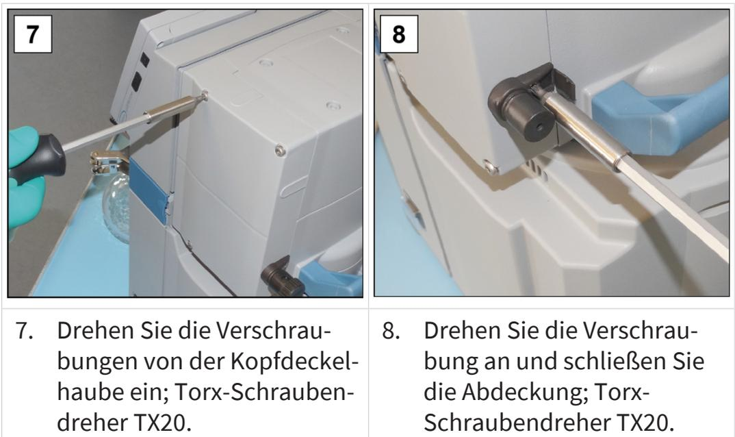
7. Drehen Sie die Verschraubungen von der Kopfdeckelhaube ein; Torx-Schraubendreher TX20.
