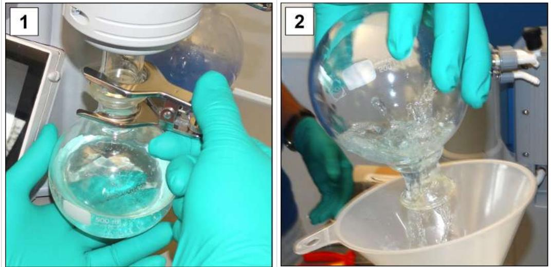
1. Öffnen Sie die Schlifffklemme und nehmen Sie den Glaskolben ab.
