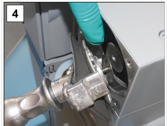
4. Heben Sie die Membran mit allen Teilen aus der Vakuumpumpe. Sollten die Distanzscheiben am Pleuel haften, nehmen Sie diese vorsichtig heraus.
