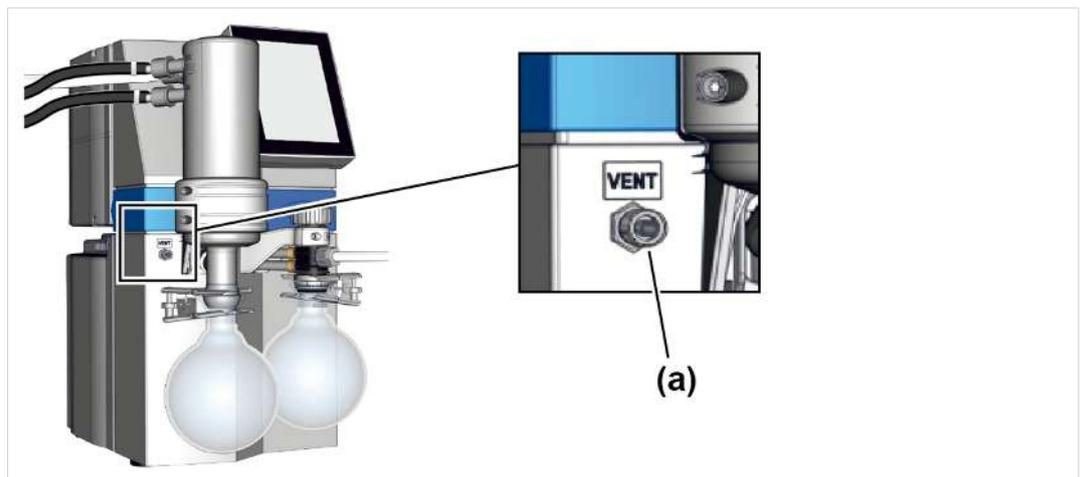
Für das Belüften mit Umgebungsluft muss am Belüftungsventil **(a)** nichts angeschlossen werden.
