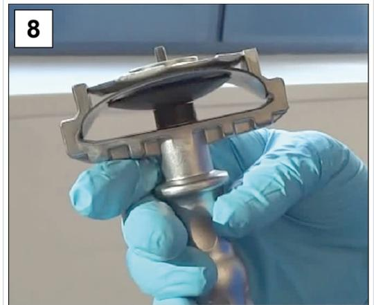
8. Fixieren Sie die Membranbaugruppe im Membranschlüssel.
