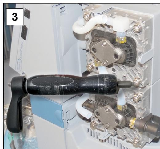
3. Drehen Sie die Verschraubungen über Kreuz mit einem Drehmomentschlüssel mit 12 Nm an.
