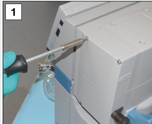
1. Drehen Sie die Verschraubungen von der Kopfdeckelhaube heraus; Torx-Schraubendreher TX20.
