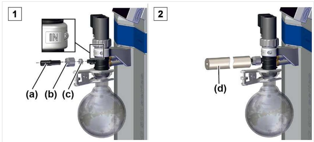
1. Verbinden Sie den Dichtring **(a)**, die Überwurfmutter **(b)** und die Schlauchwelle **(c)** wie abgebildet.
