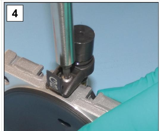
4. Drehen Sie die Verschraubung heraus; Torx-Schraubendreher TX20.
