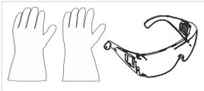
Bei Reinigungs-, Wartungs- und Instandsetzungsarbeiten empfehlen wir vollwertige Schutzhandschuhe, Schutzkleidung und Schutzbrille zu tragen.
