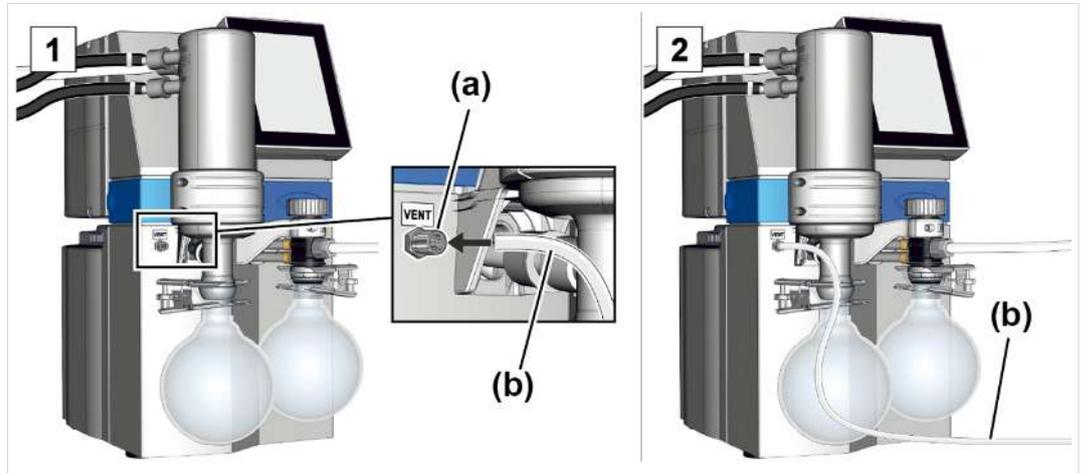
1. Stecken Sie den Schlauch **(b)** in den Anschluss VENT **(a)** und fixieren Sie den Schlauch mit der Überwurfmutter
