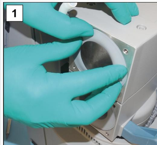
1. Drücken Sie vorsichtig die Membranen zentrisch und bündig in die Gehäuseöffnung.
