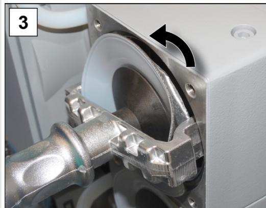
3. Setzen Sie vorsichtig den Membranschlüssel an der Membranstützscheibe an und drehen Sie mit dem fixierten Membranschlüssel die Baugruppe heraus.
