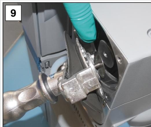
9. Halten Sie die Distanzscheiben fest und setzen Sie vorsichtig alle Bauteile auf das Pleuelgewinde.
