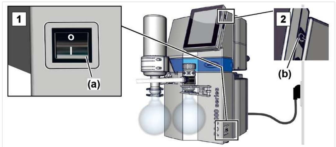
1. Schalten Sie den Wippschalter **(a)** ein – Schaltstellung **I**.
