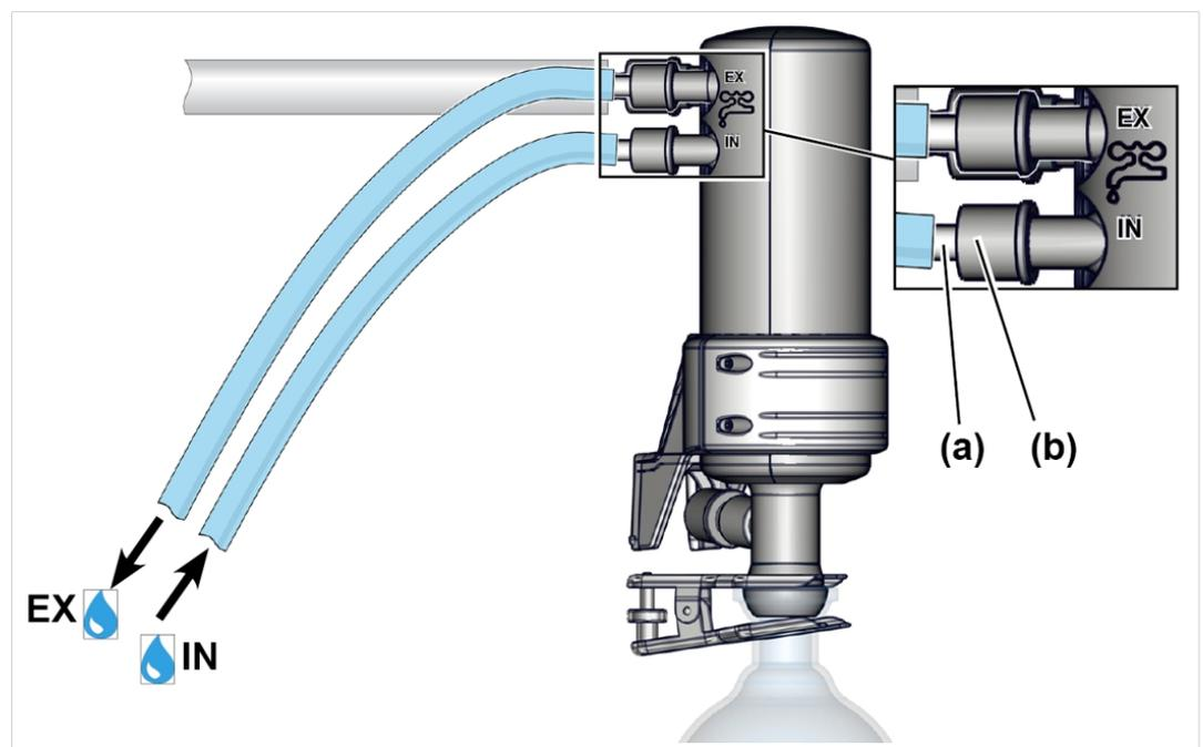
1. Befestigen Sie die beiden Schlauchwellen **(a)** mit den Überwurfmutter **(b)** wie abgebildet am Kondensator.
