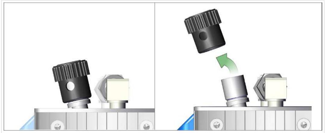
⇒ Ziehen Sie die schwarze Gasballastkappe ab und schließen Sie an der Stelle einen Gasballastadapter an.
