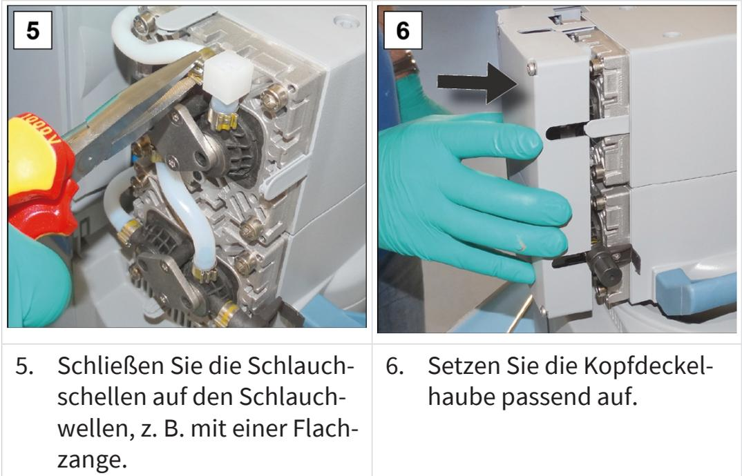
5. Schließen Sie die Schlauchschellen auf den Schlauchwellen, z. B. mit einer Flachzange.
