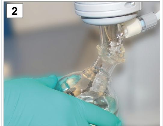
2. Entfernen Sie Glaskolben sowie angeschlossene Schläuche.
