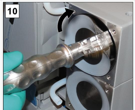
10. Drehen Sie die Baugruppe mit dem Membranschlüssel zunächst handfest an.
