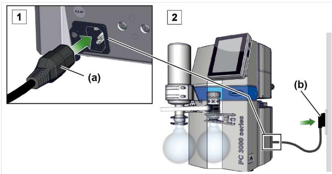
1. Stecken Sie die Buchse **(a)** vom Netzkabel in den Netzanschluss der Vakuumpumpe.
