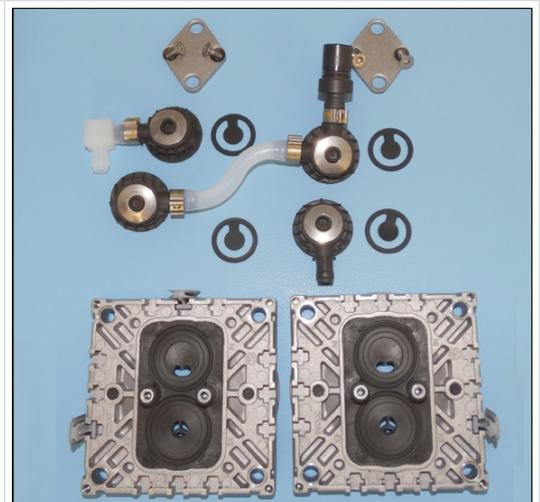
Draufsicht: Bauteile Ventilinseln, Ventile und Pumpenkopfpaar.
