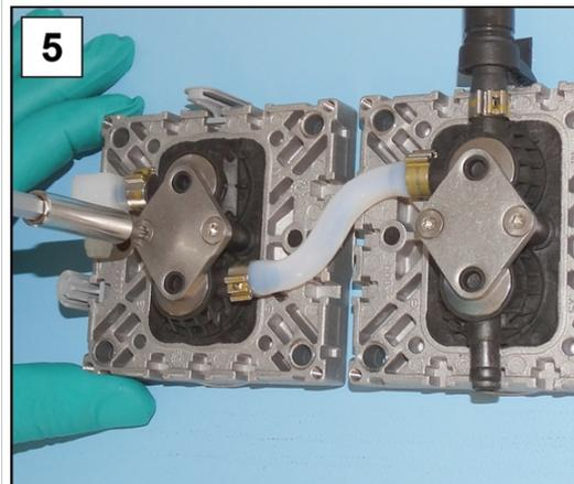
5. Drehen Sie die Torxschrauben an den Spannpratzen heraus; Torx-Schraubendreher TX20.
