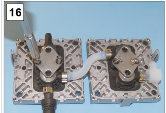
16. Legen Sie die Spannpratzen auf die Ventilinseln und drehen Sie die Verschraubungen handfest an.
