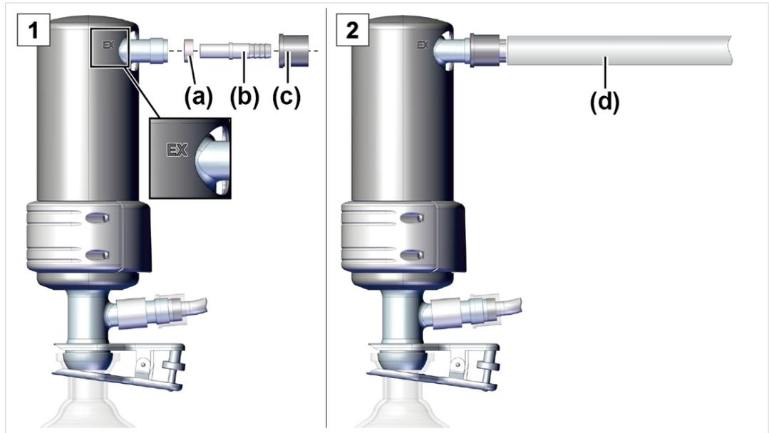
1. Verbinden Sie den Gummi-Dichtring **(a)**, die Schlauchwelle **(b)** und die Überwurfmutter **(c)** wie abgebildet und schrauben Sie dies auf den Anschluss.
