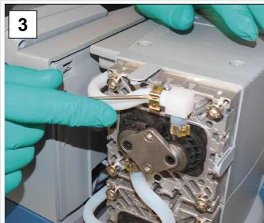
3. Öffnen Sie die Schlauchschellen der äußeren Schläuche. Schlitzschraubendreher Größe 1.
