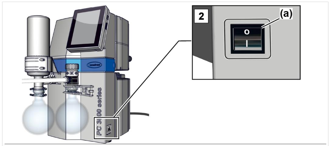
2. Schalten Sie den Wippschalter **(a)** aus – Schaltstellung 0.
