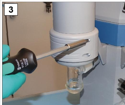
3. Drehen Sie die Schrauben vom Gegenhalter heraus; Torx-Schraubendreher TX10.
