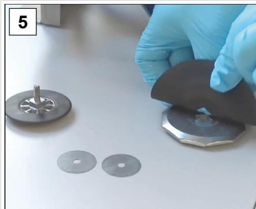
5. Ziehen Sie die Membranspannscheibe heraus und entfernen Sie die gebrauchte Membran.
