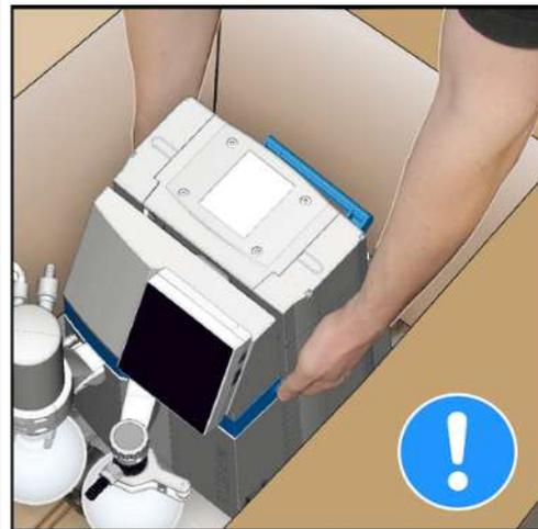
Beachten Sie, dass das Gewicht eines Pumpstands mehr als 20 kg betragen kann. Heben Sie das Gerät an den seitlichen Griffmulden aus der Verpackung. Niemals Anbauteile wie Halter oder Glaskolben als Hebehilfe benutzen. Nutzen Sie ausschließlich die seitlichen Griffmulden und/oder den Handgriff für den Weg zum Aufstellungsort.
