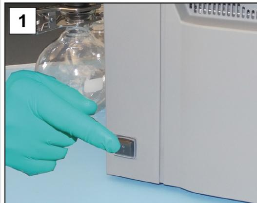
1. Schalten Sie den Pumpstand aus und ziehen Sie den Netzstecker.
