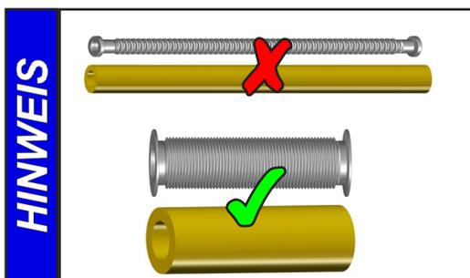
Kürzest mögliche Vakuumverbindungsleitungen großer Nennweite verwenden, um Drosselverluste zu vermeiden.
