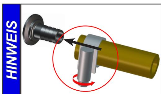
Schlauchverbindungen geeignet gegen unbeabsichtigtes Lösen sichern (z.B.: Schlauchschellen verwenden).
