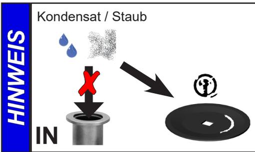
Kondensation in der Pumpe, sowie Flüssigkeitsschläge und Staub vermeiden, da eine Dauerförderung von Flüssigkeiten oder Staub Membrane und Ventile schädigt.
