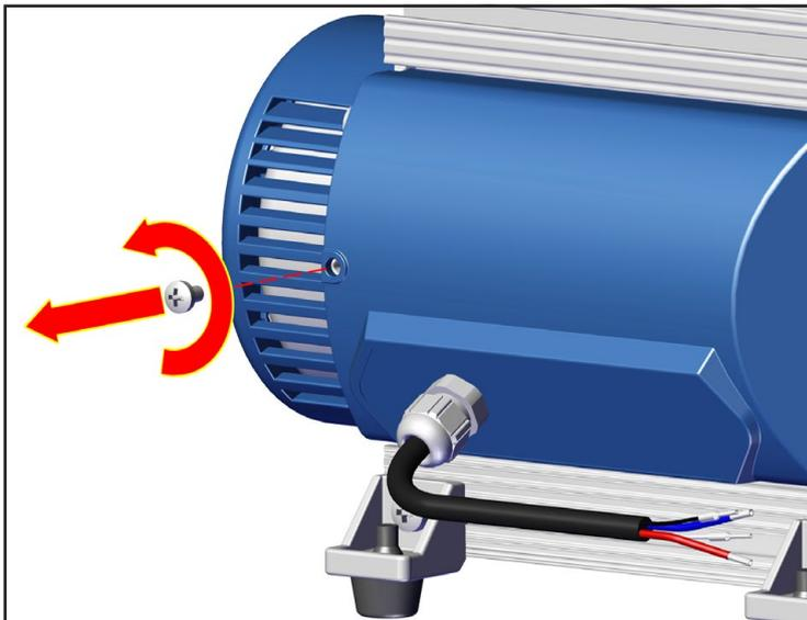
Schraube an der Abdeckung herausdrehen.
