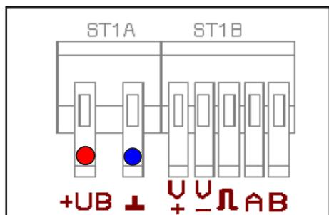
☞ Sicherstellen, dass kein Steuersignal anliegt, z.B. durch Abziehen des weißen und schwarzen Kabels vom Klemmenblock ST1B.
