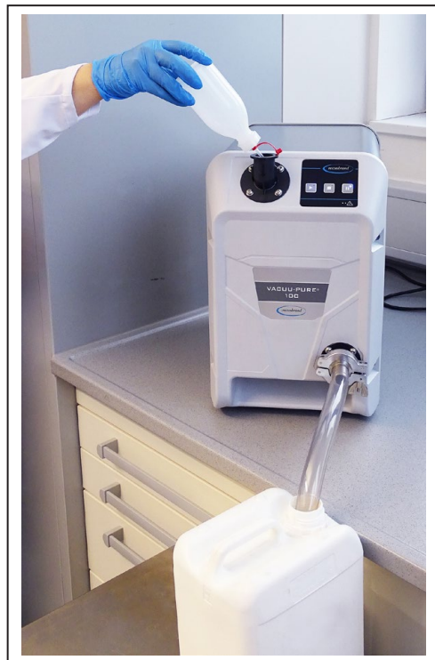
Beispielhafte Anordnung zum Spülen der Vakuumpumpe
