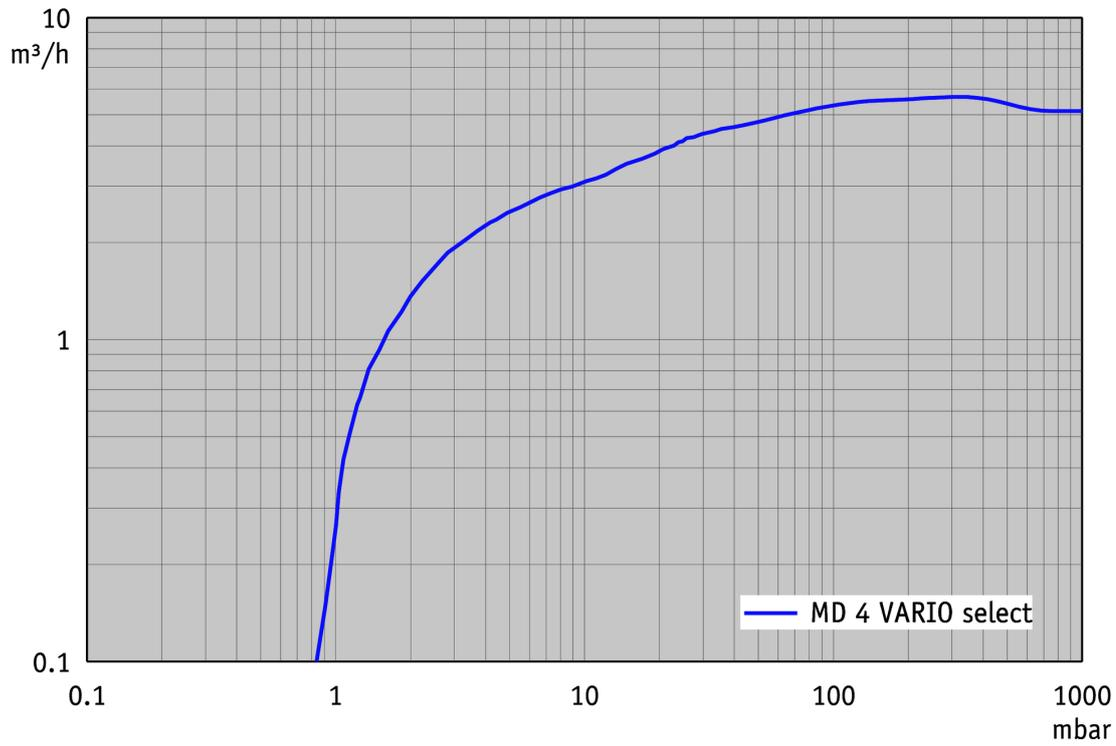
Courbe de pompage à 50 Hz (réservoir 10 l)
