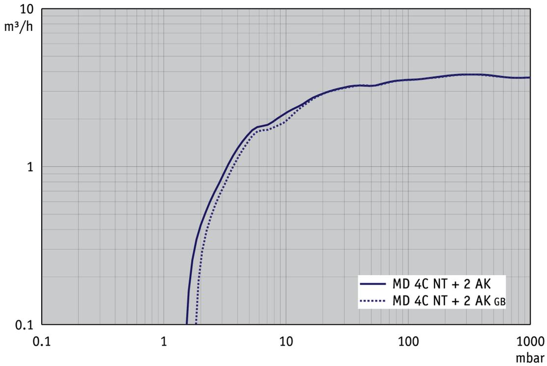
Abpumpkurve bei 60 Hz (10 l Behälter)
