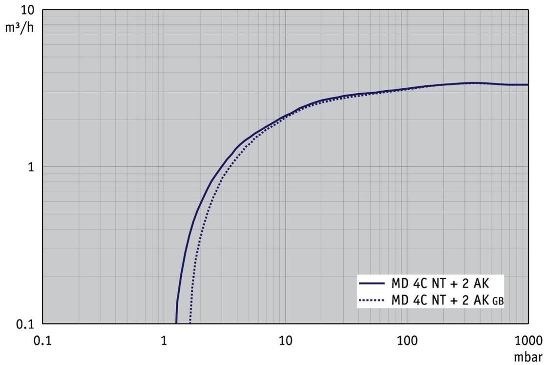
Abpumpkurve bei 50 Hz (10 l Behälter)
