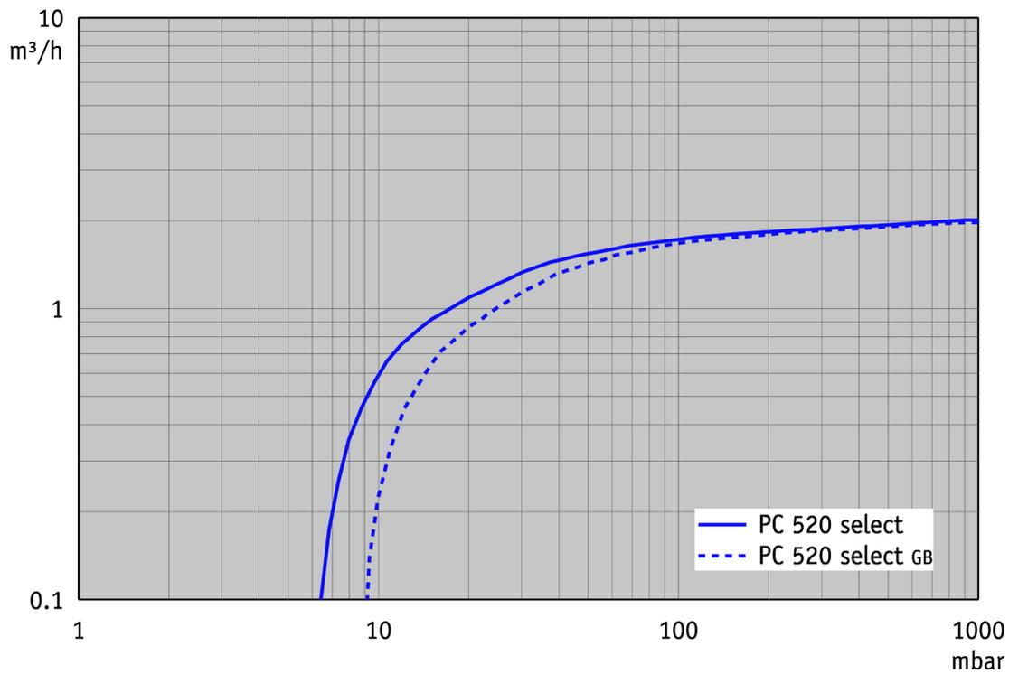
Abpumpkurve bei 50 Hz (10 l Behälter)
