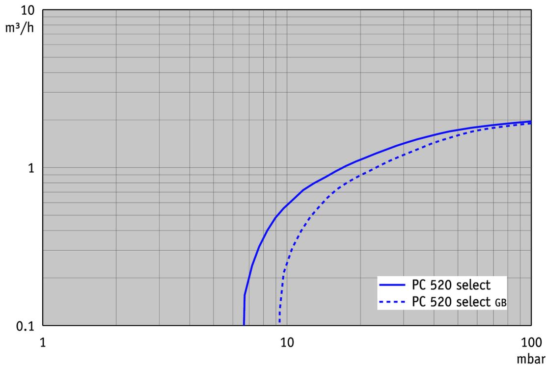
Abpumpkurve bei 60 Hz (10 l Behälter)
