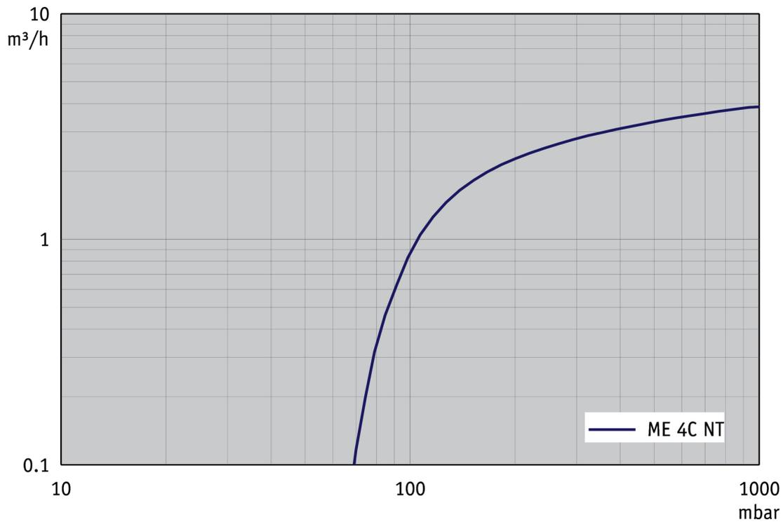
Abpumpkurve bei 50 Hz (10 l Behälter)
