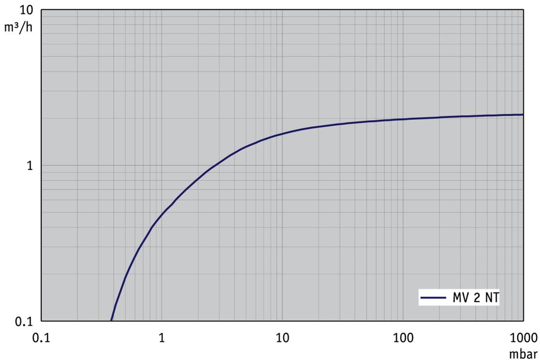
Abpumpkurve bei 50 Hz (10 l Behälter)
