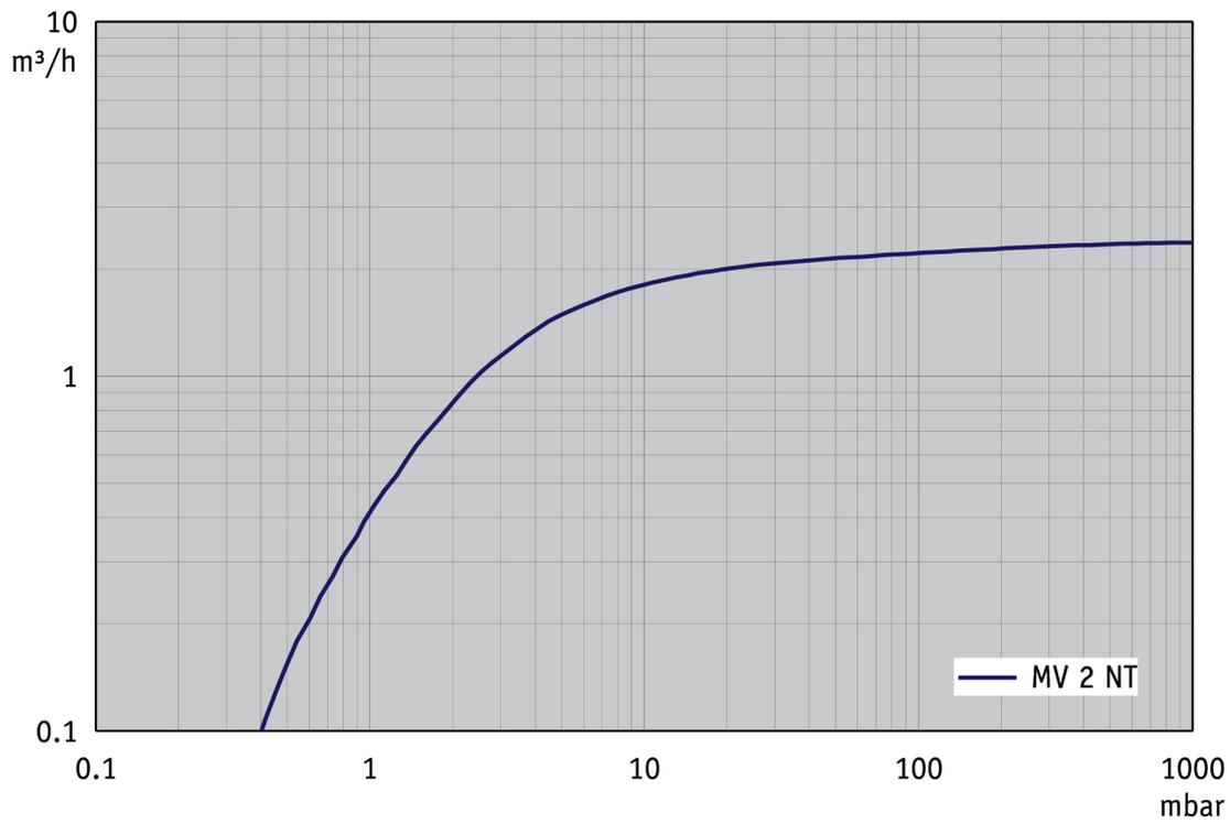
Abpumpkurve bei 60 Hz (10 l Behälter)
