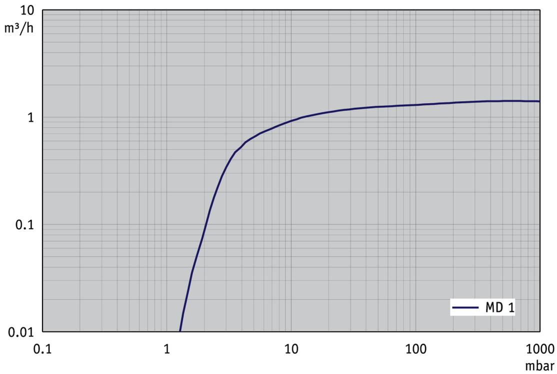
Abpumpkurve bei 60 Hz (10 l Behälter)
