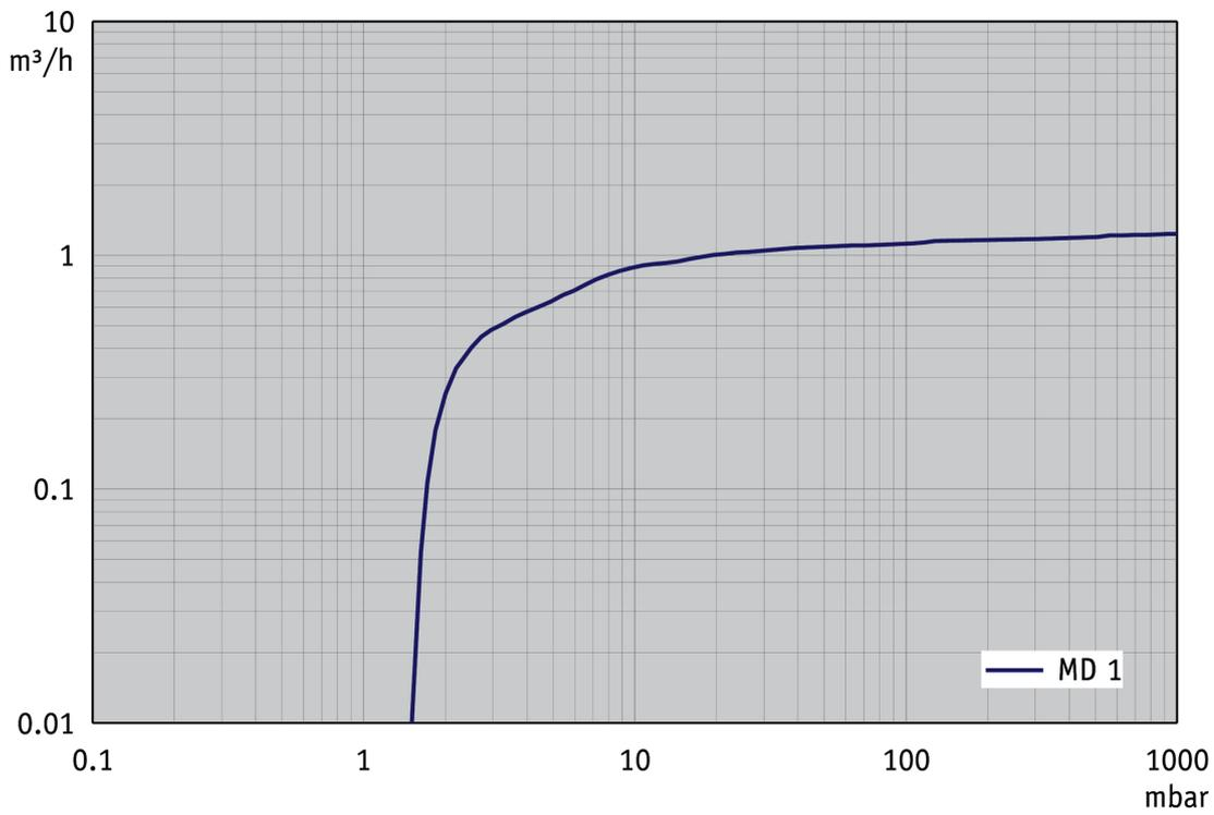
Abpumpkurve bei 50 Hz (10 l Behälter)
