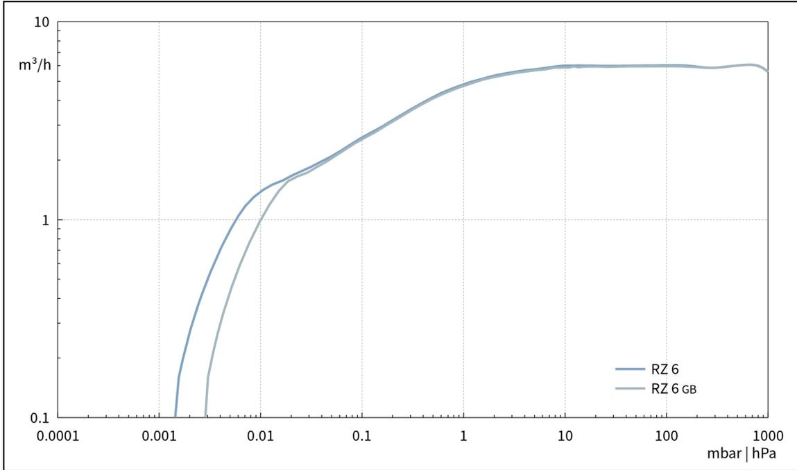
Abpumpkurve bei 50 Hz (10 l Behälter)
