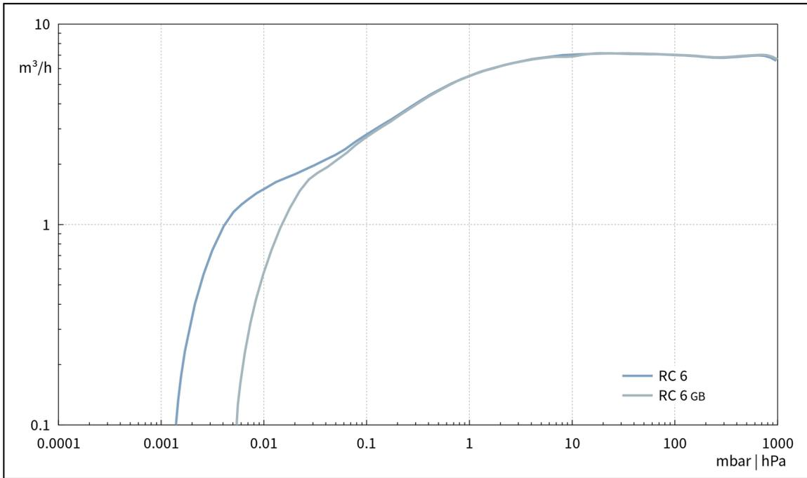
Abpumpkurve bei 60 Hz (10 l Behälter)
