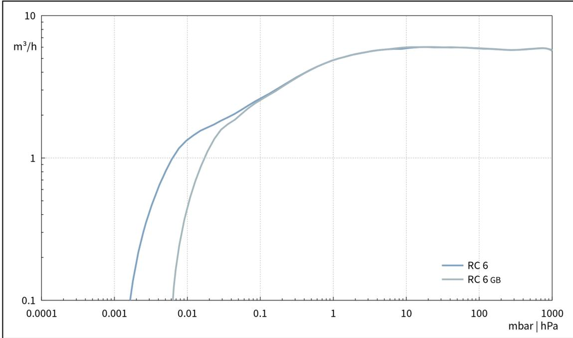
Abpumpkurve bei 50 Hz (10 l Behälter)
