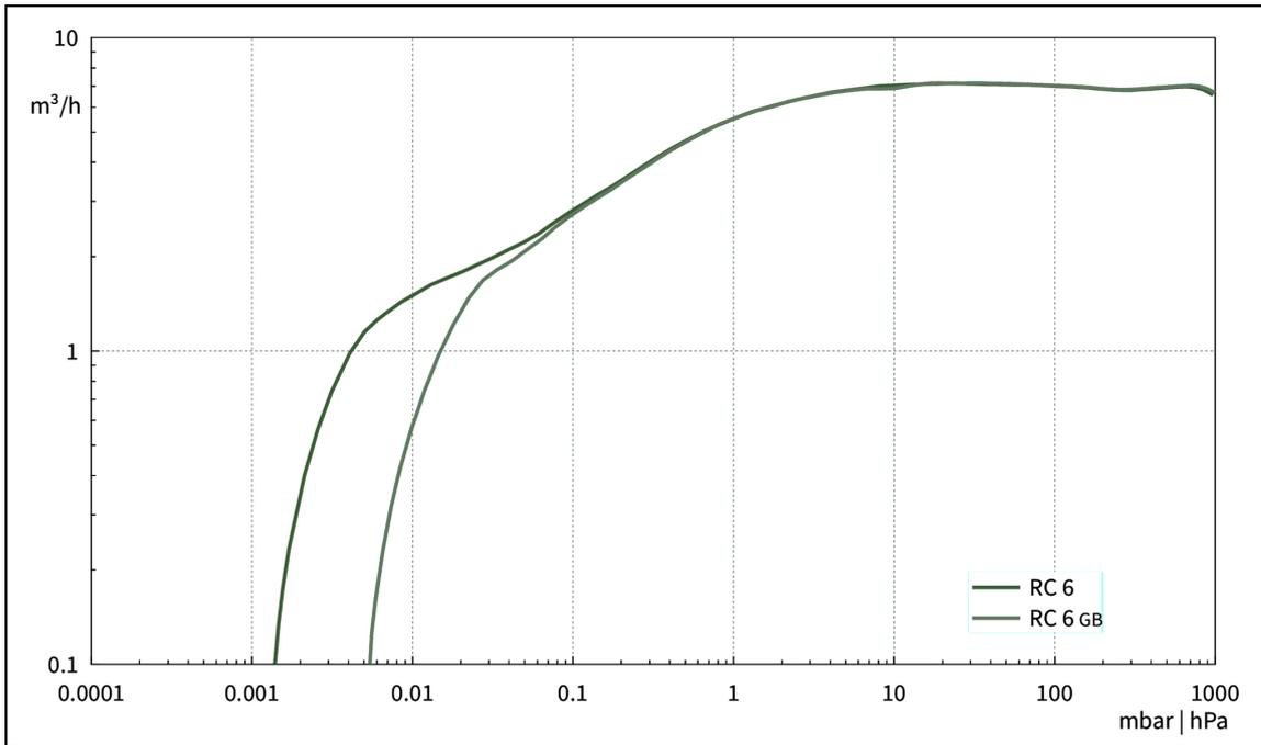
Abpumpkurve bei 60 Hz (10 l Behälter)
