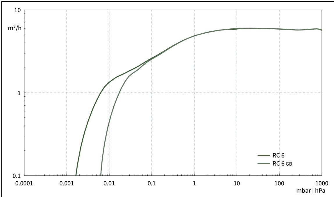
Abpumpkurve bei 50 Hz (10 l Behälter)
